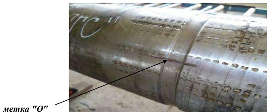
Рисунок 10.19 Метка «0» на корпусе скважинного прибора.
