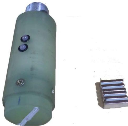
Рисунок 6.2.6. Датчик глубины с постоянными магнитами
