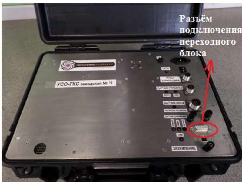
Рисунок 9.2.3. Разъём подключения переходного блока на панели УСО
