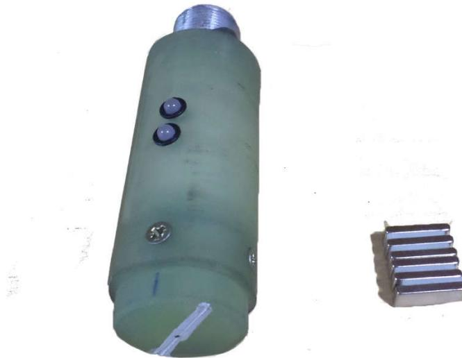
Рисунок 6.2.6. Датчик глубины с постоянными магнитами
