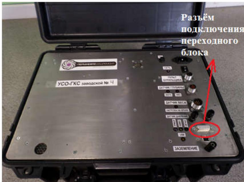
Рисунок 9.2.3. Разъем подключения переходного блока на панели УСО
